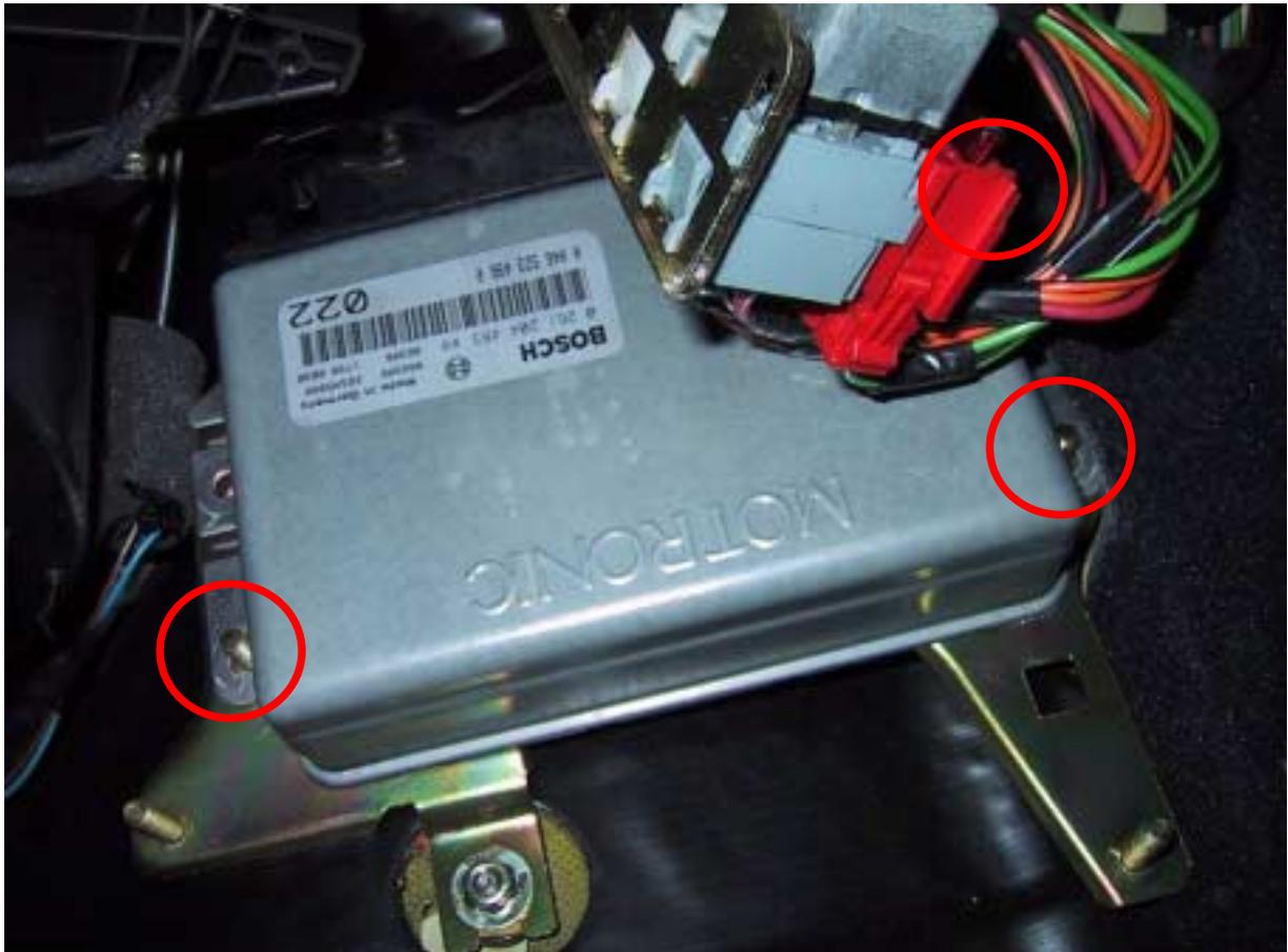
Das Steuergerät ist mit drei 10-er Muttern auf einem Blechträger befestigt. Diese müssen vorsichtig gelöst werden. Beim Abheben des Steckschlüssels darauf achten, dass die Mutter nicht hinter dem Teppich runterrutschen. Sind die Muttern weg, kann das Steuergerät von dem Blechträger abgehoben und freigemacht werden.
