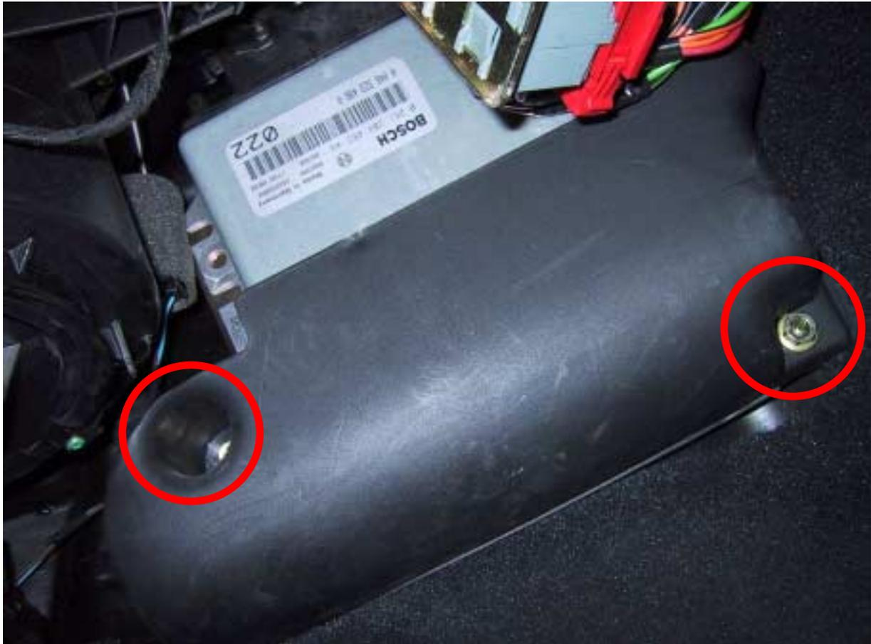
Das Motorsteuergerät befindet sich im Beifahrerfußraum oben rechts. Zuerst muss die Kunststoffschutzabdeckung entfernt werden. Dazu werden mit einem 10 Steckschlüssel die beiden angezeichneten Muttern gelöst. Nun kann die Abdeckung weggehoben werden. Das Steuergerät ist jetzt frei zugänglich.
