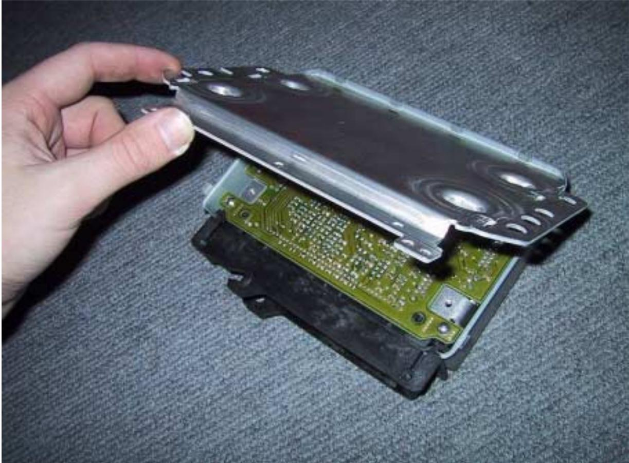
Der obere massivere Teil des Gehäuses (Grundplatte) kann nun zuerst vorne etwas angehoben und dann rausgezogen werden. Es soll darauf geachtet werden, dass beim Anheben die nicht bearbeiteten Laschen nicht verbogen werden.
