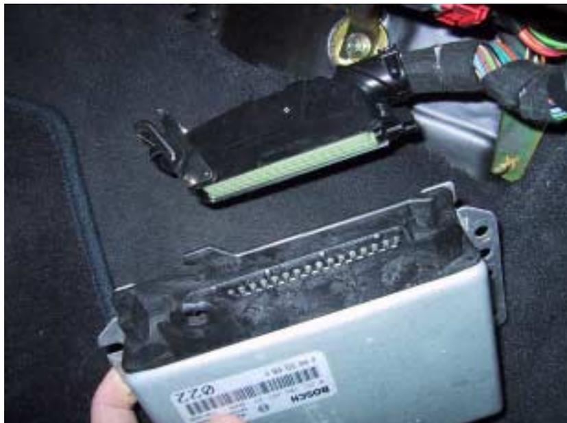
Der Stecker weist eine ausgeklügelte Verbindungsmechanik auf, welche es erlaubt die Verbindung ohne Werkzeug und hoher mechanischer Beanspruchung zu lösen. Dazu muss einfach der Bügel auf der Oberseite des Steckers nach links geschwenkt werden. Die Steckverbindung wird durch die Schwenkbewegung des Bügels automatisch gelockert. Der Stecker lässt sich jetzt leicht nach rechts wegschwenken und lösen.
